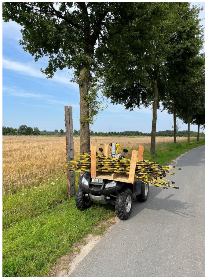
6-litziger, mobiler Schutzzaun Auf- und Abbau je 5-7 h
