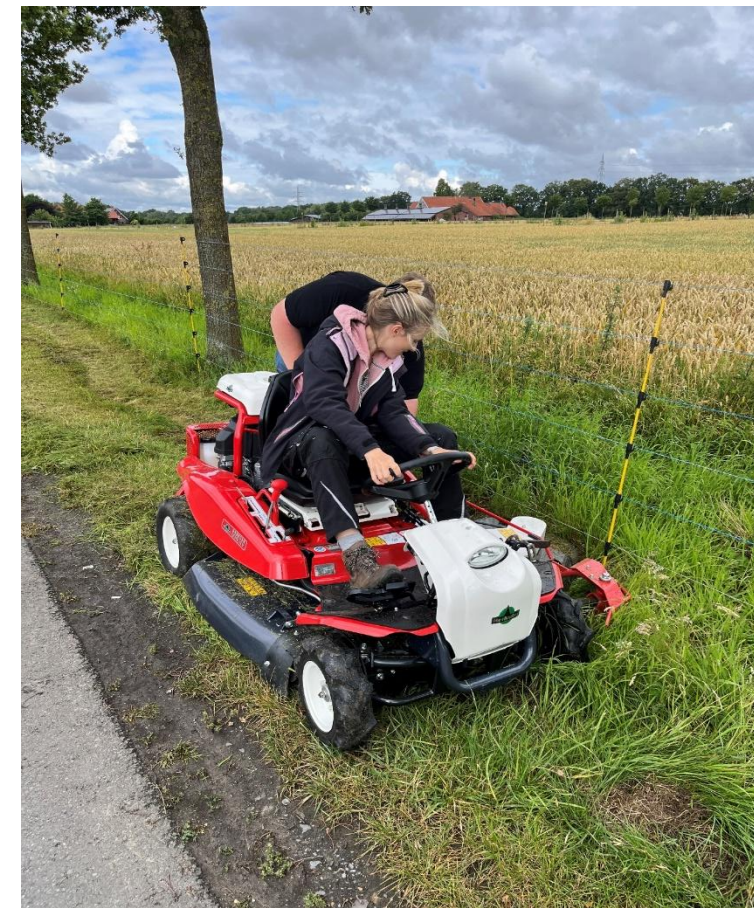
Freihalten der unteren Litze mit Gestrüppmäher alle 4 W ca. 2,5 h
